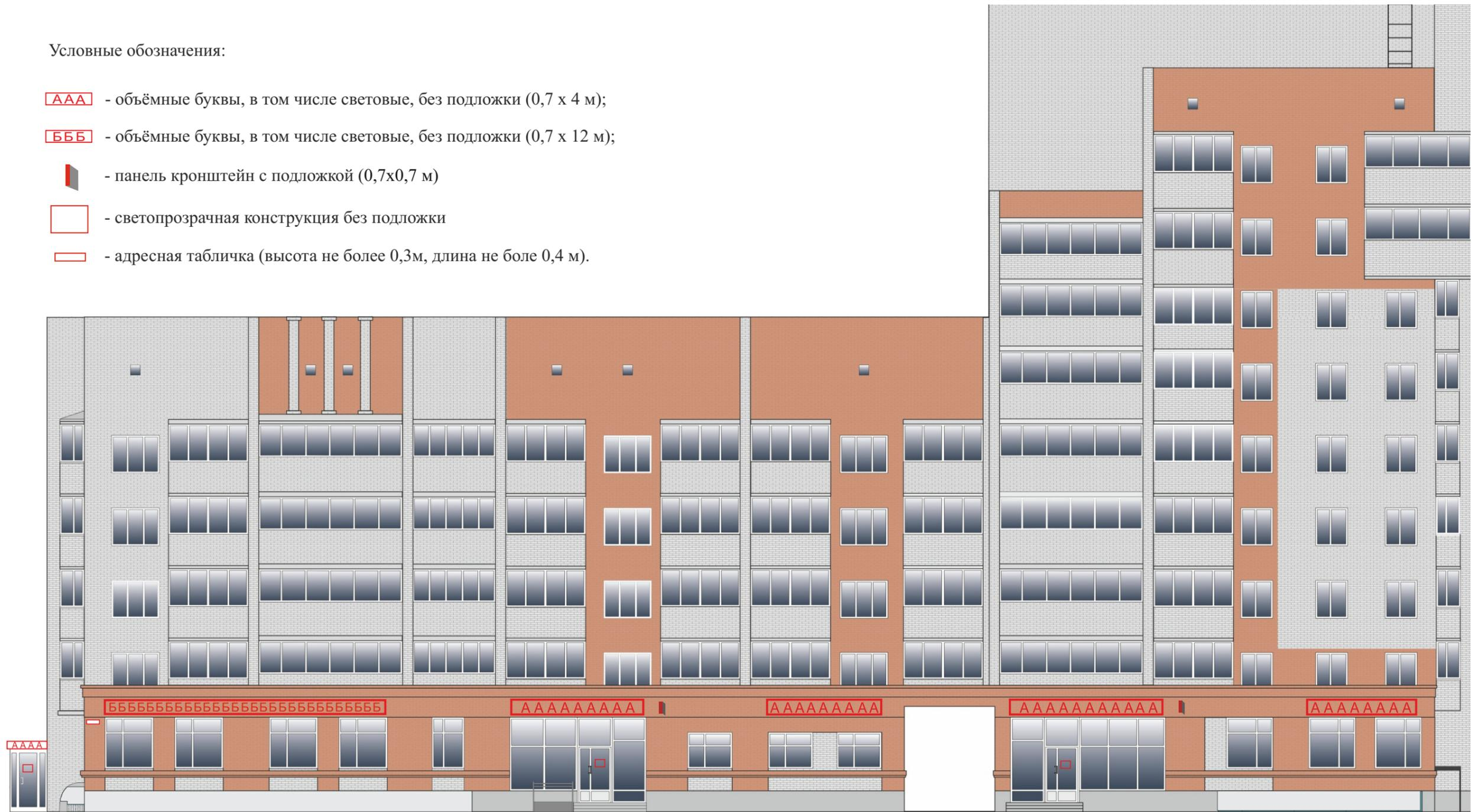
Схема возможных мест размещения информационных конструкций (вывесок), информационных табличек, указателей и витрин, входных групп и отдельных элементов с условными обозначениями и размерами:
