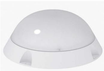
Светодиодный светильник «ВАРТОН» антивандальный с микроволновым датчиком<br>Характеристики:<br>Мощность, Вт: 10<br>Световой поток, Лм: 1000<br>Цветовая температура, К: 4000<br>Степень защиты, IP: 65<br>Размеры, мм: 185*70<br>Тип рассеивателя: матовый<br>Тип монтажа: накладной<br>Особенности: микроволновый датчик |
